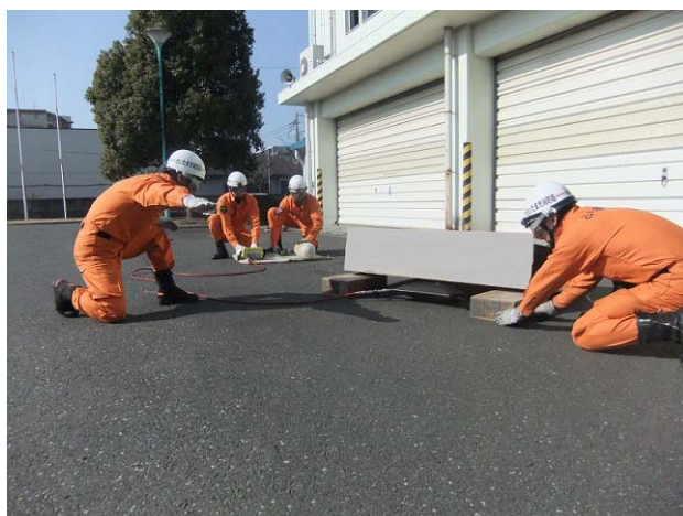
【マット型空気ジャッキ救助取扱訓練】
