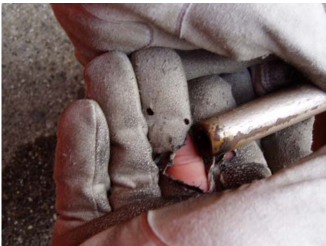
パイプから炎が噴出し火傷した状況
