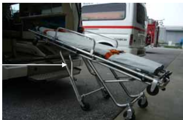
脚部が伸展していない状態。
