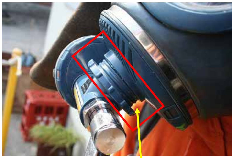
緩んでいる状態
