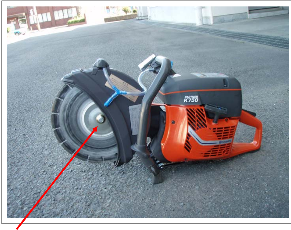
ネジが緩み回転していた刃が本体から離脱
