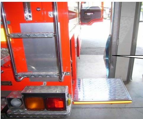
写真1のように、車両右後部のボックスの扉を開けたまま前進し、柱を覆っているアルミカバーを破損する。
