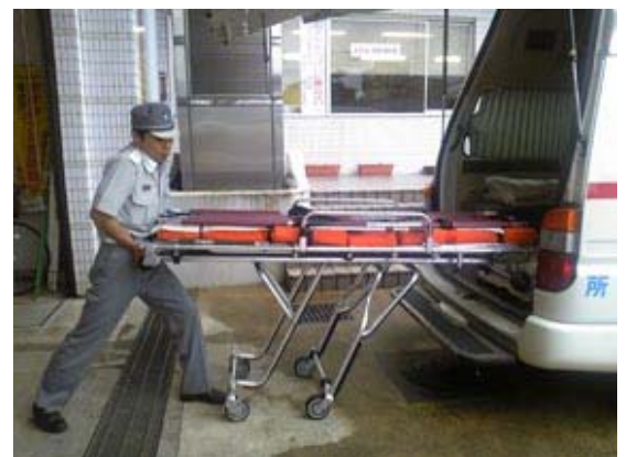
頭側の脚がロックされずストレッチャーが落下する
