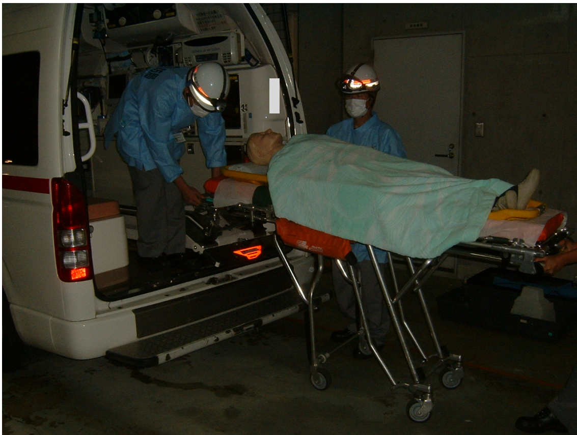
救急活動中傷病者を降ろす際、ストレッチャーの足が下がった事例
