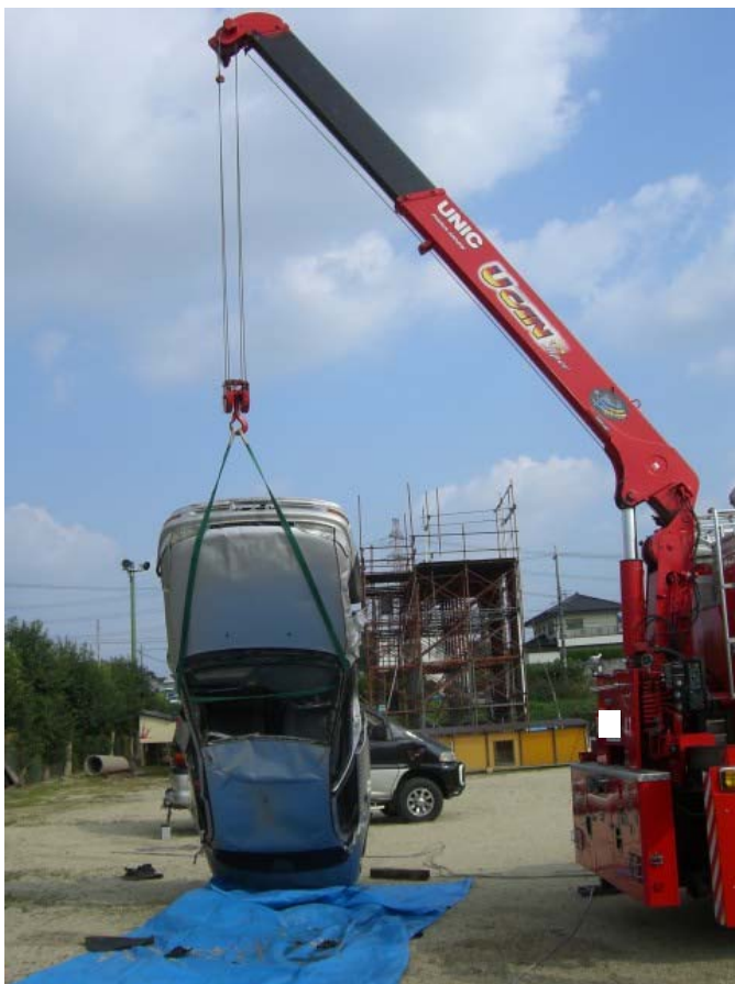
縦吊りにて復旧させるための の吊り上げ作業中
