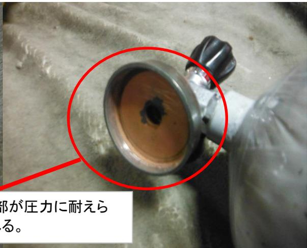
劣化によりネジ部が圧力に耐えられずに突然外れる。
