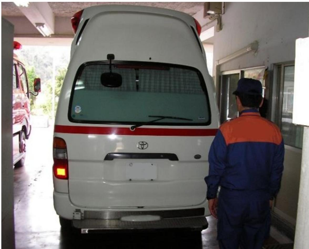
車両後方に点検員が立っているため、後退灯確認時、急に車両が動き出した際は、車両に巻き込まれる危険性がある。
