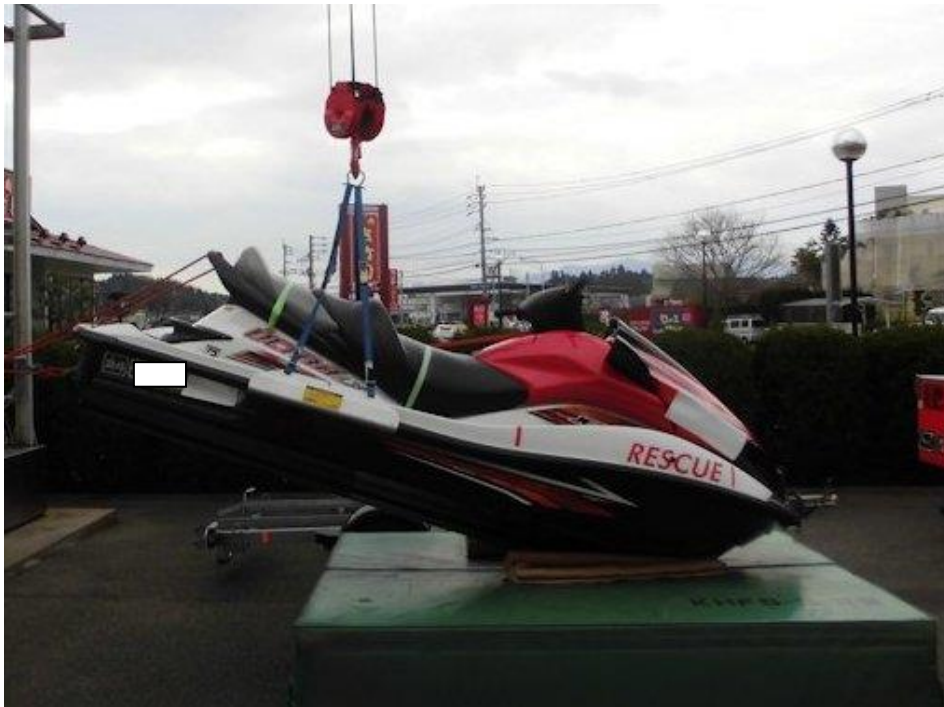
ヒヤリハット発生時の状況（重心の変化によりジェットハーネスが滑る）
