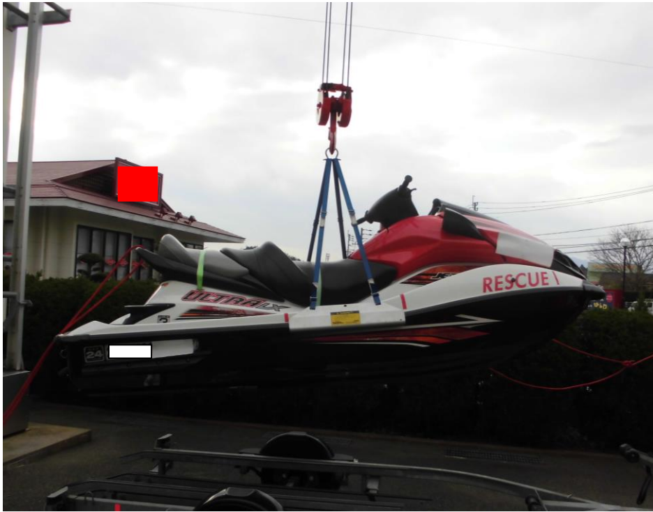
水上バイクをジェットハーネスで吊り上げた状態
