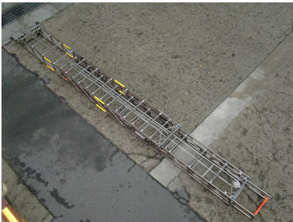
三連はしごの2連目、3連目同時伸てい状況の全体写真（再現）
