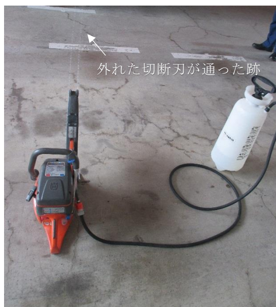
切断刃が外れたエンジンカッター
