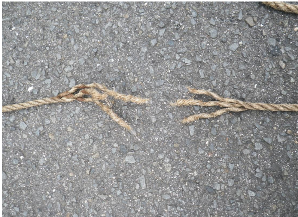
破断箇所の拡大写真
