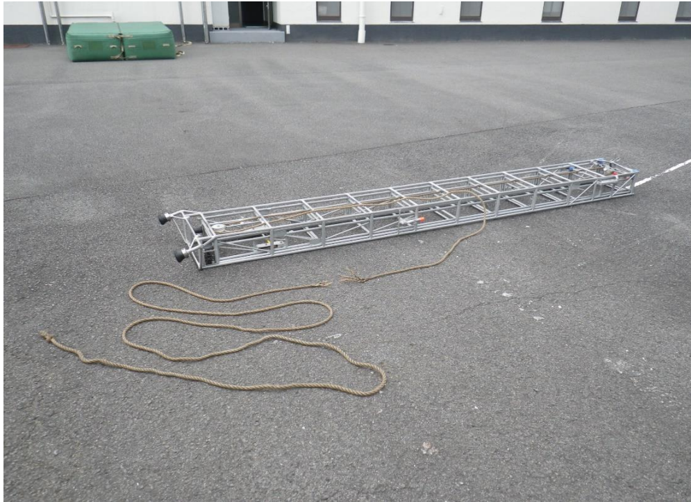
引き綱が破断した三連はしごの全体写真
