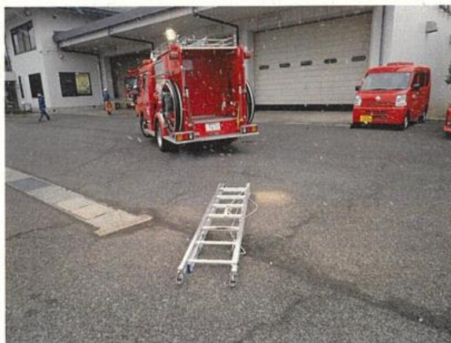
車両移動時、梯子が落下したもの
